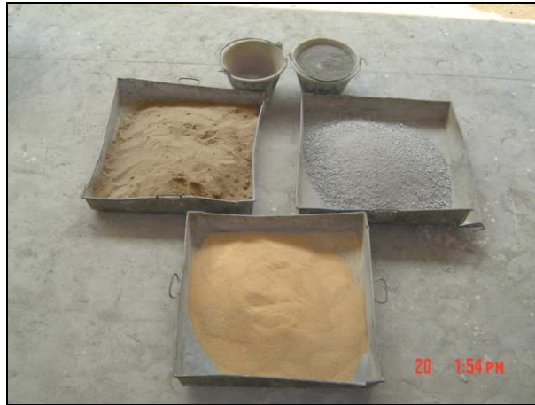
รูปที่ 2.1 วัสดุที่ใช้ในการทำบล็อกประสาน ที่มา : วินิต ช่อวิเชียร (2539)
